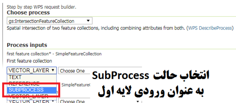
شکل ۳۷- انتخاب حالت SubProcess به عنوان ورودی حالت اول در تحلیل Intersection
