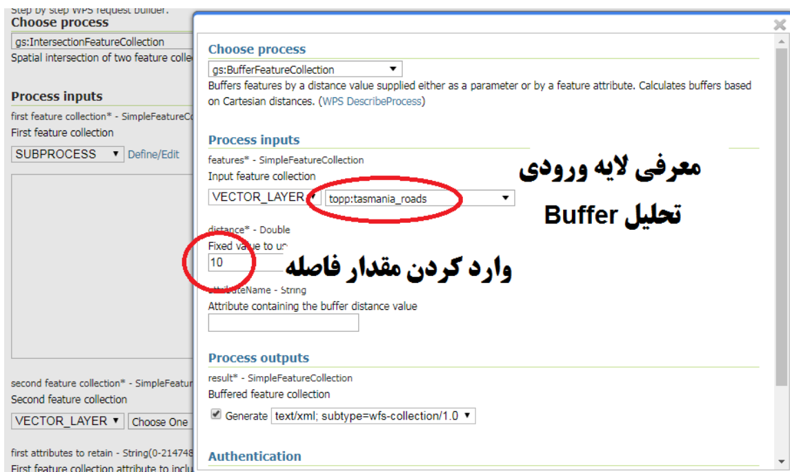
شکل ۴۰- انتخاب لایه ورودی از تحلیل Buffer و تعیین مقدار فاصله
