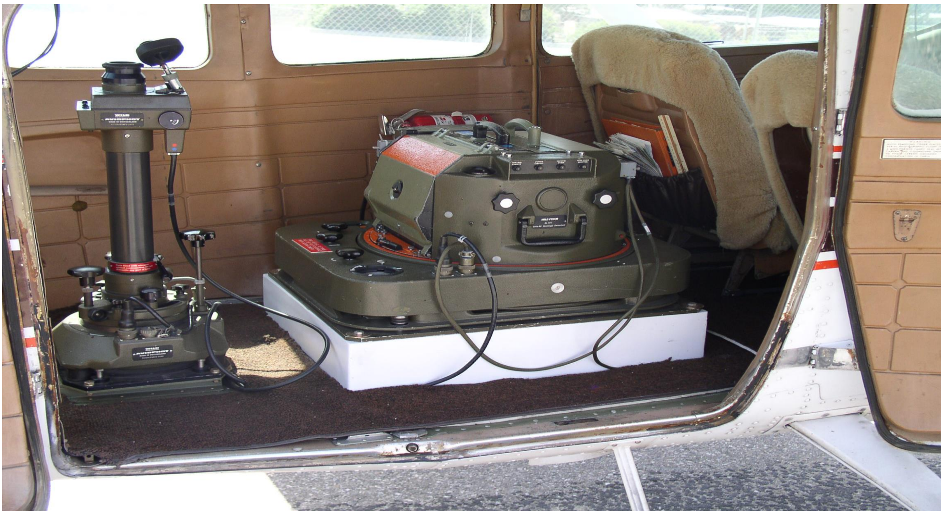
دوربین آنالوگ مدل RC20 مورد استفاده در سازمان نقشه برداری کشور
