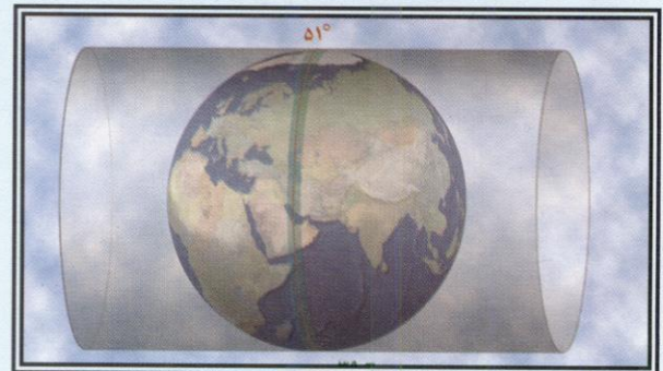
شکل ۴. نحوه قرار گرفتن زمین در سیستم تصویر UTM
