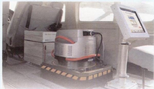
شکل ۸. سیستم نصب شده سنجنده ADS40 محصول شرکت Leica Geosystems
