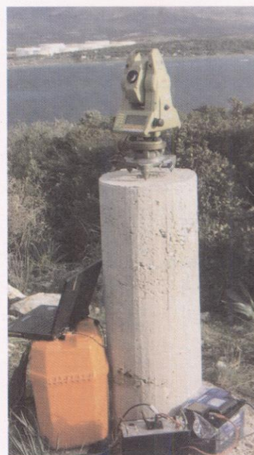
شکل ۵. سیستم ردیابی: Total Station رباتیک (خودکار)
