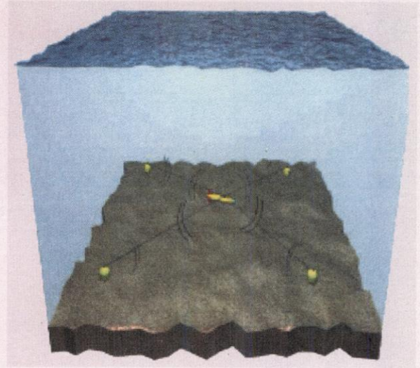
شکل ۱. تعیین موقعیت طول باز بلند
