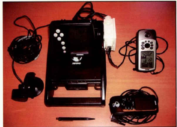
شکل ۱. نمایی از تجهیزات مورد استفاده در عملیات آبنگاری شامل عمق یاب GPS، متصل به عمق یاب، ترانس دیو سر و کابل ها
