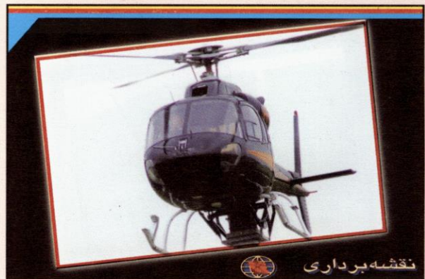
شکل ۱. سیستم HELI-SURVEY (دوربین عکسبرداری در قسمت پایین بالگرد نصب شده است)
