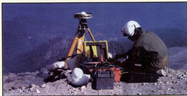
نگاره ۳. اندازه گیری ایستگاههای مرجع
