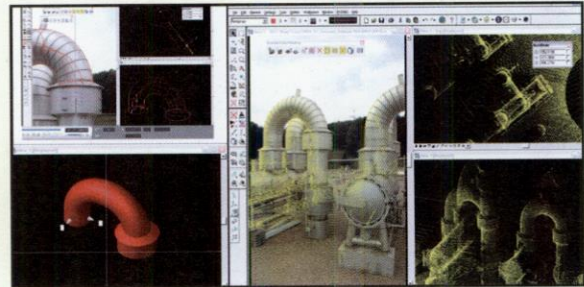
شکل ۳. ترسیم عوارض موجود بر روی تصویر به کمک نقاط لیزری و مدل‌سازی سه بعدی
