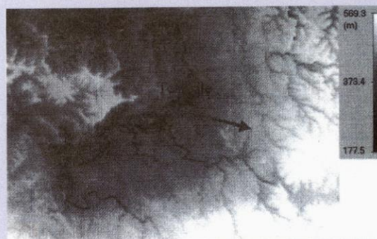
شکل ۷. DEM به دست آمده از InSAR بعد از به کار بردن تصحیحات به کمک نقاط GPS
