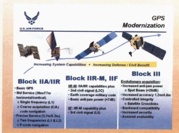
شکل ۲. GPS Modernization در یک نگاه: ماهواره‌های IIA-17، IIR-9 و IIR-3، IIF-30 هم اکنون در مدار بوده و ماهواره‌های IIR-3، IIF-16 و IIR-7/8 طبق برنامه زمانبندی شده پرتاب خواهند شد.
