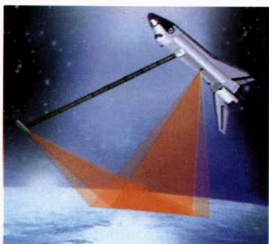
نگاره ۳. سیگنالهای رادار تابش و بازتابش برای تهیه داده های SRTM [۵]
