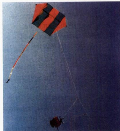
نمایی از یک بادبادک که بادبانی به آن آویزان شده و این بادبان، دوربین و بخش کنترل رادیویی را نگه داشته است.
