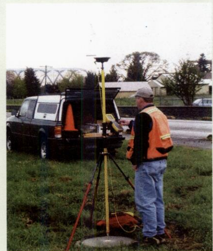
ایجاد ایستگاه های کنترل اولیه با استفاده از RTK GPS، به منظور استفاده در موسسه حمل و نقل Oregon
