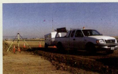
ایستگاه مبنای RTK GPS برای تعیین محدوده فرودگاه بین المللی Medford در Rogue Valley
