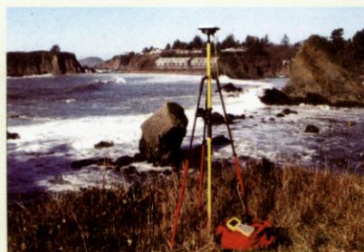
استفاده از RTK GPS جهت کنترل منطقه‌ای در امتداد سواحل Oregon جنوبی
