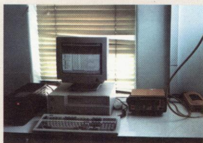
نگاره ۳. گیرنده و کامپیوتر ایستگاه دائم
