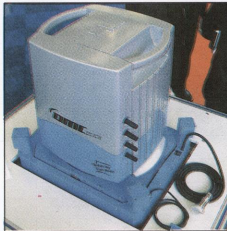
سیستم DMC: ابعاد CCD در این سیستم ۱۲ میکرون است که با انتخاب فاصله کانونی ۵۰ میلیمتر برای عدسی و سرعت پرواز ۷۰ متر بر ثانیه و ارتفاع ۳۰۰ متر برای هواپیما ابعاد پیکسل زمینی DMC معادل ۷ سانتی متر قابل دسترسی خواهد بود.
