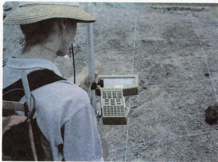
شکل ۱- با استفاده از سیستم GPS در سال ۱۹۹۸، هارداکر توانست داده‌های میدانی را با دقت سانتی متر ثبت نماید.
