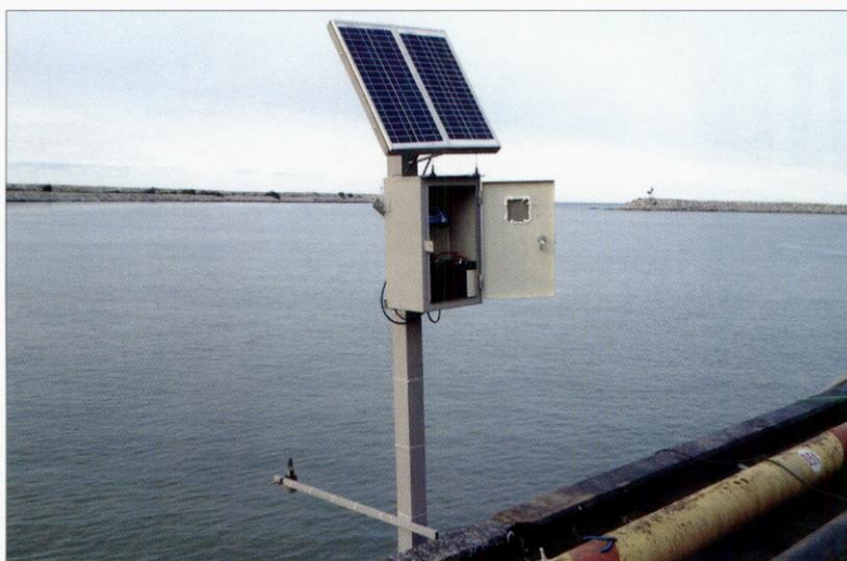
دستگاه جزر و مد سنج مجهز به سنجنده فراصوتی در کشور ساخته شد
