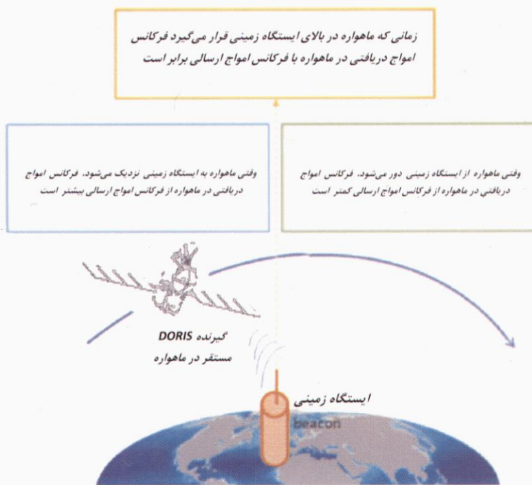
شکل ۲: نحوه عمل سامانه DORIS
