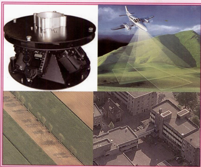
شکل ۴. مثالی از سیستم رقومی تصویربرداری مایل چنددوربین (یک دوربین قائم و چهار دوربین مایل) و تصویر حاصل که برای کاربردهای استخراج اطلاعات بزرگ مقیاس مانند کاداستر بسیار مناسب است
