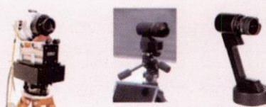
شکل ۱۷. مثال‌هایی از دوربین پانورامیک با ابعاد فریم بسیار بزرگ تا یک گیگا پیکسل
