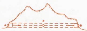
نگاره ۲- حفاری تونل از دو طرف مقابل هم
